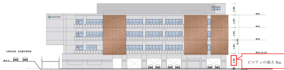
◆図2：浸水対策を施した市町村庁舎の例（ピロティ形式、愛知県清須市）
