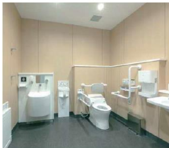
多目的トイレの例
