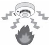
住宅用火災警報器は、すべての寝室と寝室が2階などの場合、階段室の天井付近に設置する必要があります。住宅用火災警報器は、古くなると電子部品の寿命や電池切れなどで、火災を感知しなくなることがあります。10年を目安に交換をおすすめします。またホコリの蓄積や電池切れを起こしている場合があるので、定期的に作動確認しメンテナンスを行いましょう。
