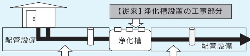
【新規】配管工事：生活雑排水を浄化槽に流入及び浄化槽で処理した水を放流する為に必要な工事
